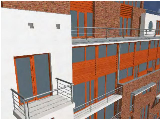
Этот же проект, открытый в ArchiCAD 9 и представленный с помощью механизма визуализации LightWorks, имеет следующий вид. Благодаря трассировке лучей происходит отражение от стеклянных поверхностей и намного лучше представлено отбрасывание теней.
